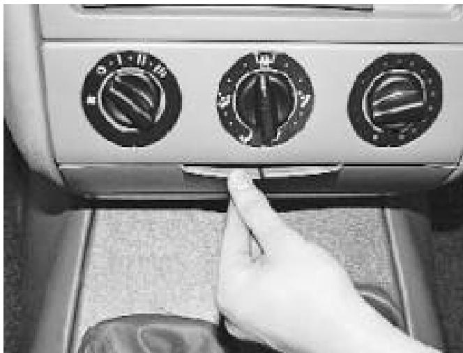
**20 – гнездо для радиоаппаратуры.** Предусмотрена установка радиоаппаратуры, соответствующей по размерам и способу крепления международным стандартам.
