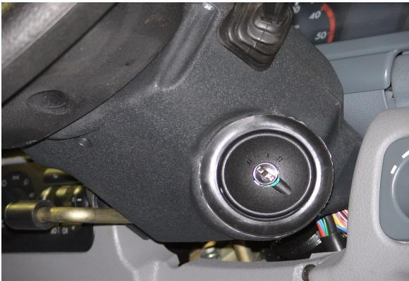
0 – «выключено». Положение фиксированное, ключ вынимается. При вынутом ключе срабатывает запирающий механизм противоугонного устройства. Для гарантированного блокирования вала рулевого управления поверните рулевое колесо вправо или влево до щелчка. Для выключения механического противоугонного устройства нужно вставить ключ в выключатель (замок) зажигания и, слегка поворачивая рулевое колесо вправо-влево, повернуть ключ в положение «I»;
