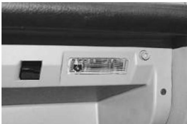
**Нижний вещевой ящик оснащен плафоном освещения с выключателем. Плафон освещения работает только в том случае, если ящик открыт.**
