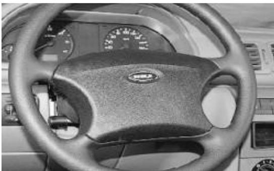
**3 – выключатель звукового сигнала.**
