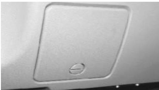
28 – крышка монтажного блока предохранителей и реле.
