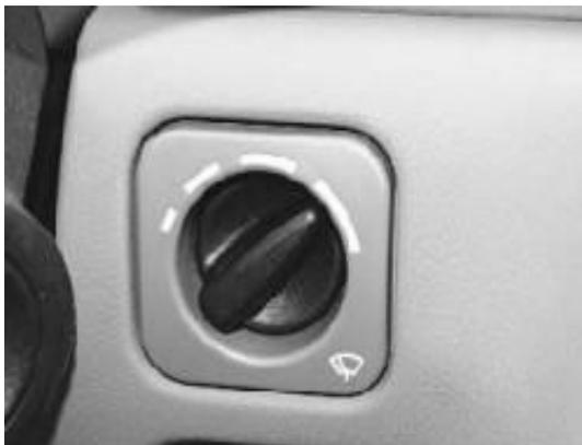
**7 – переключатель паузы работы стеклоочистителя** может занимать пять фиксированных положений. Вращением рукоятки изменяют время паузы в работе стеклоочистителя.
