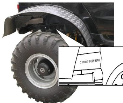
Рисунок 1.3 Расположение идентификационного номера шасси
