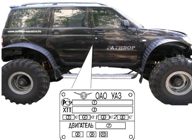
Рисунок 1.1 Заводская табличка автомобиля:
