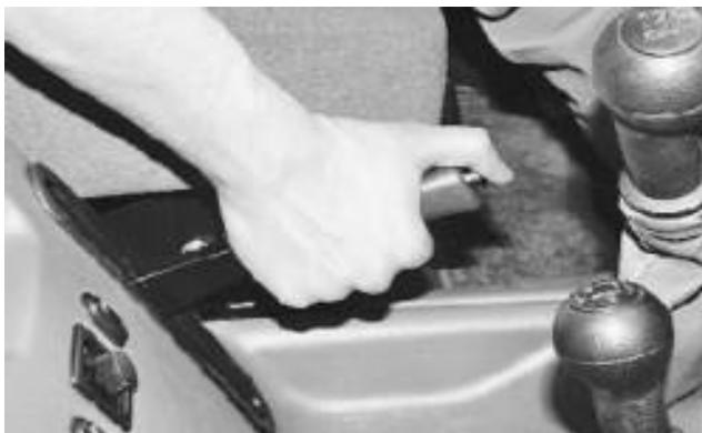
**23 – рычаг стояночного тормоза.** Для того чтобы поставить автомобиль на стояночный тормоз, поднимите рычаг до упора вверх. В комбинации приборов загорится красным цветом контрольная лампа, задние колеса заблокируются. Для того чтобы снять автомобиль со стояночного тормоза, потяните рычаг немного вверх...
