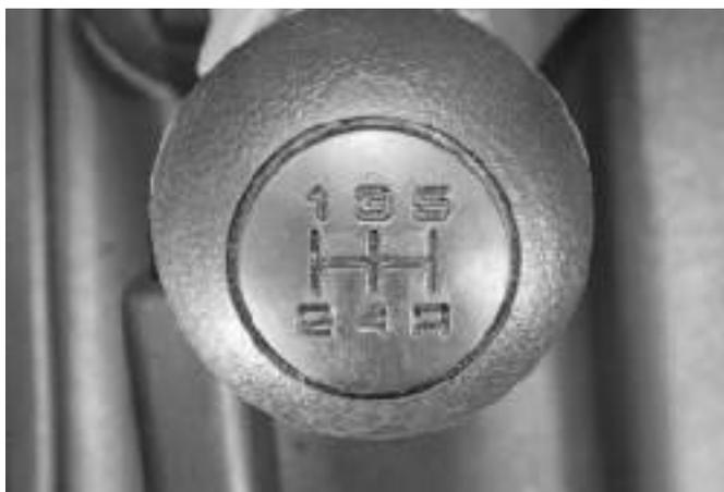
**22 – рычаг переключения передач.** Коробкой передач управляйте согласно схеме переключений, нанесенной на рукоятку ее рычага. В нейтральном положении рычаг
