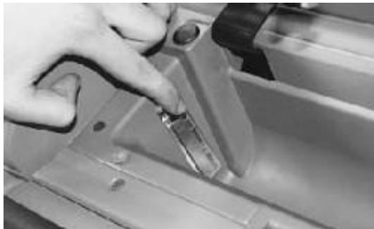
**Верхний вещевой ящик оснащен плафоном освещения с выключателем.**
