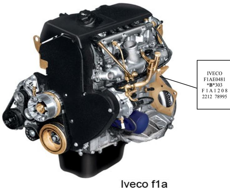
Рисунок 1.4 Расположение идентификационного номера двигателя:
