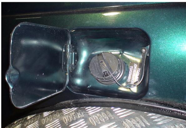
Рисунок 3.14 Лючок и пробка топливного бака
