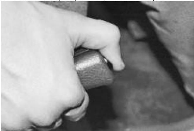
...нажмите на кнопку на торце рукоятки рычага и отпустите рычаг до упора вниз. Контрольная лампа должна погаснуть.
